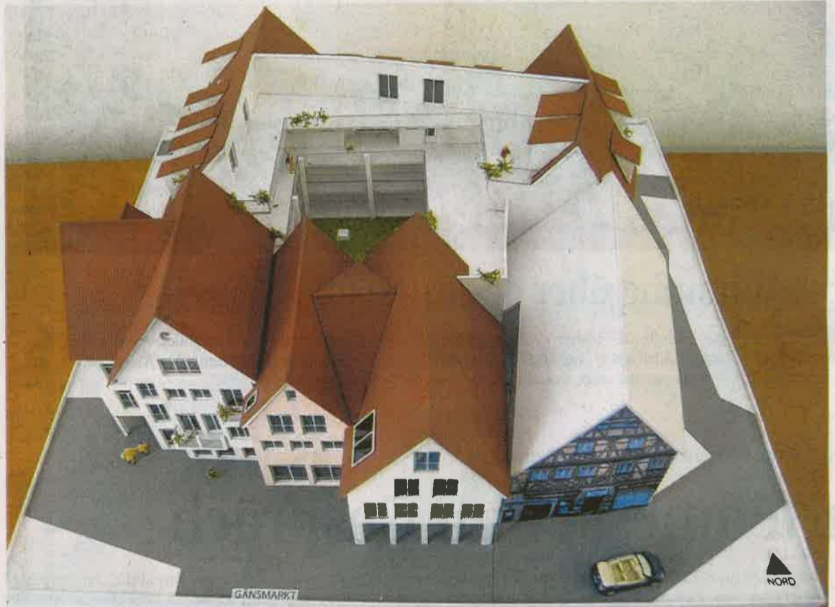
Der neue Gebäudekomplex zwischen Gänsmarkt (vorne) und Unterer Mauergasse (hinten): 21 Wohn- und ein bis zwei Gewerbeeinheiten sind hier geplant. Im rückwärtigen Teil sollen auf der Erdgeschossebene 15 Pkw-Stellplätze entstehen. Das Zentrum des Wohn- und Geschäftshauses bleibt auf Höhe des ersten Obergeschosses offen und unbebaut. Vorne rechts ist übrigens das Eiscafé „Cortina“ auf dem Modell mit abgebildet
